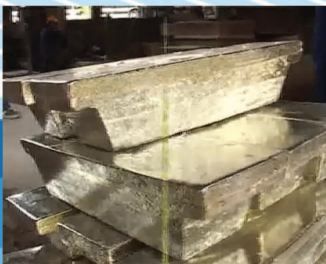
Sản xuất thiếc xuất khẩu Sn = 99,95 và 99,99% được luyện tại Viện hiện nay
