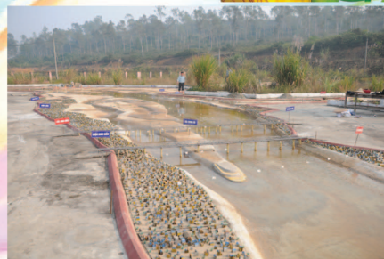
Nghiên cứu chỉnh trị khu vực phân lưu sông Hồng, sông Đuống trên mô hình vật lý tại khu thí nghiệm Hòa Lạc
