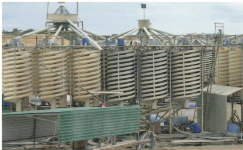
Hệ thống tuyển vớt dùng phục vụ khai thác titan do Viện nghiên cứu, chế tạo
